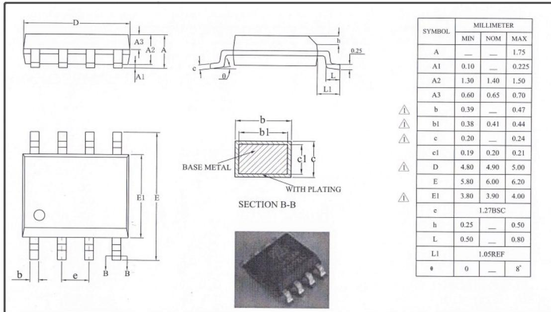
图 1-5 SOP8 封装 POD 图
