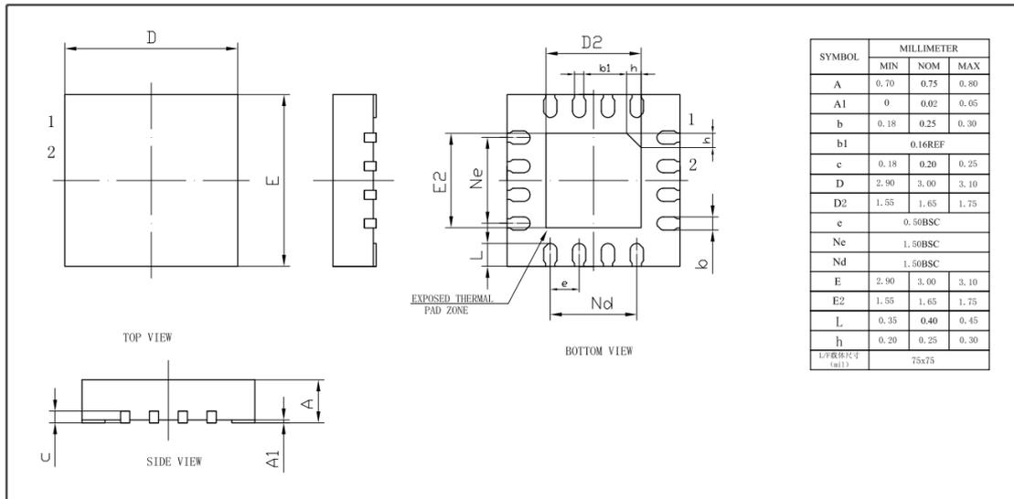
图 1-8 QFN16 封装 POD 图
