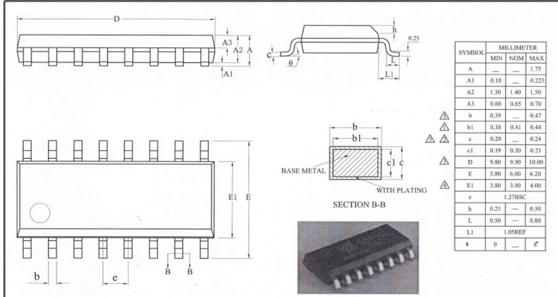
图 1-7 SOP16 封装 POD 图
