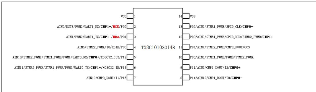
图 1-2 TX8C1010S014B (SOP14) 引脚图
