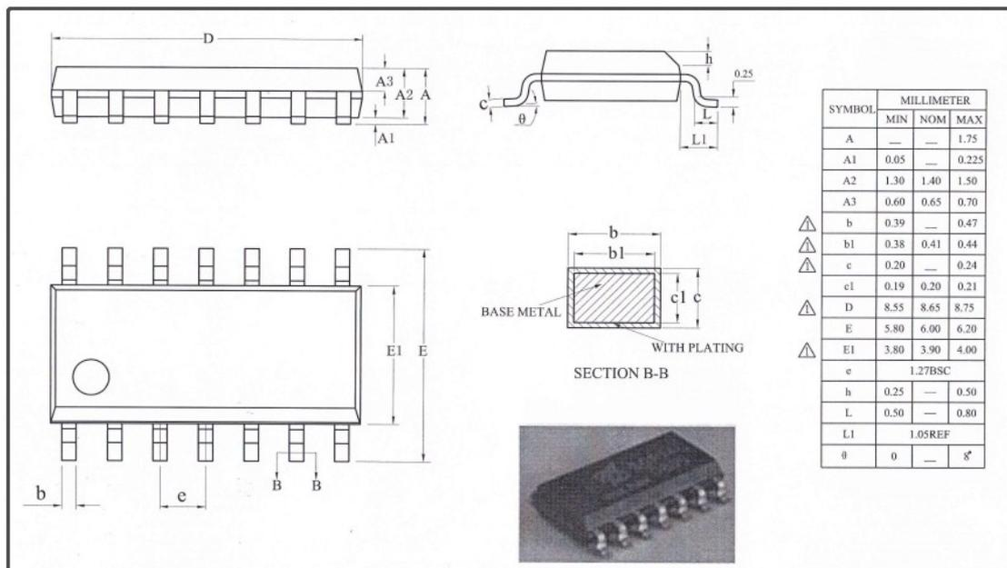
图 1-6 SOP14 封装 POD 图
