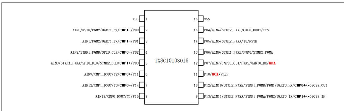
图 1-3 TX8C1010S016 (SOP16) 引脚图
