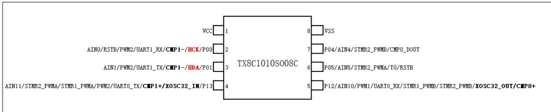
图 1-1 TX8C1010S008C (SOP8) 引脚图
